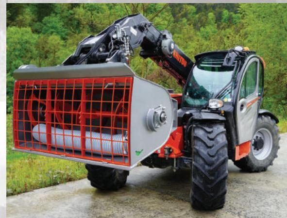
“ Maximale Lebensdauer durch verschleißfeste Stähle: Hardox / Sidur.
